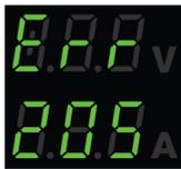
Das in der Grafik links dargestellte Beispiel zeigt an, dass die Versorgungsspannung in der Stromquelle fehlerhaft ist.
